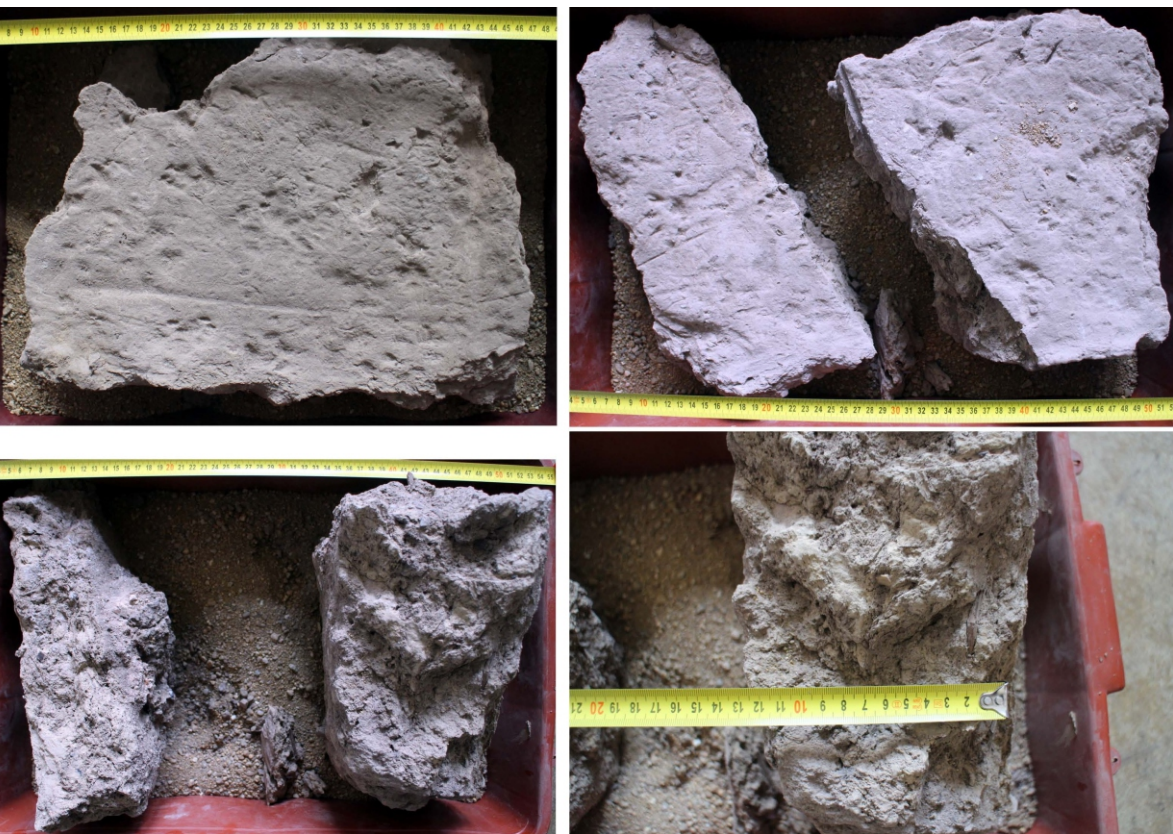
Les blocs du torchis du pan de bois de la maison de la deuxième moitié du 13 e siècle.
