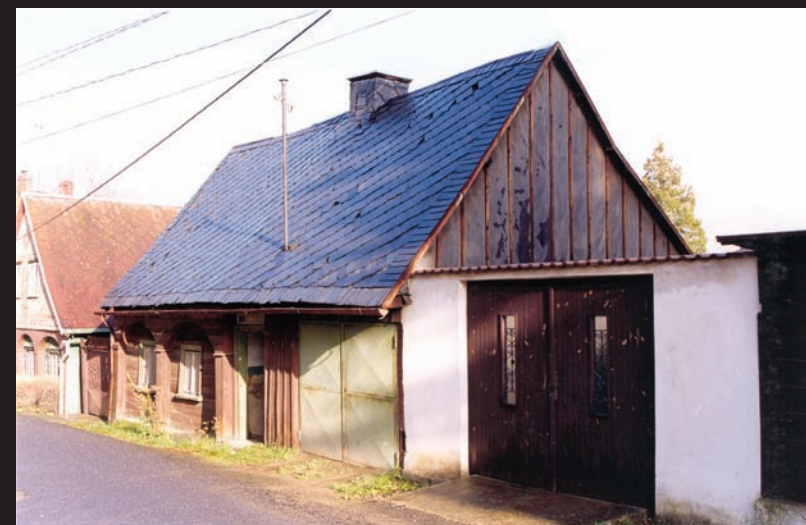
LEPENICE / KONSTRUKCE HRÁZDĚNÉ: Přízemní hrázděný dům z koce 18. století (1780 / 1783) s roubenou obytnou místností, dřevohliněným komínem a stropní konstrukcí hrázděné části z latí obalovaných slámou máčenou v hliněné břečce; Šluknov čp. 310 (Šluknov)
