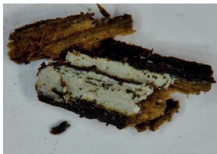
Obr. 4: Asi zatím nejmenší plodnice živé dřevomorky (cca 2 x 1 cm), námi nalezené v podkroví jednoho z pavilonů v Psychiatrické nemocnici v Bohnicích v Praze 8.
