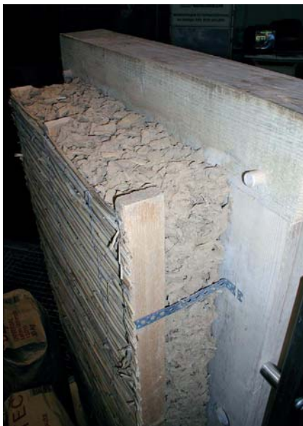
Obr. 2: Přezdívková deska z lehčeného jíl (Leichtlehm) vloženého do bednění.
