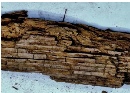
Obr. 5: Typický rozklad dřeva působením hub hnědé hniloby.
